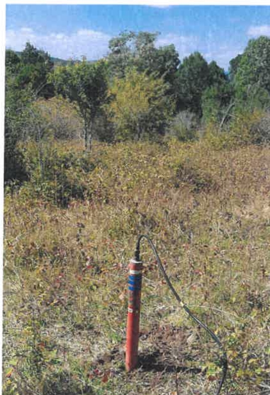
Slika 6. Prikaz sonde koje se koriste pri magnetotelurskom snimanju
