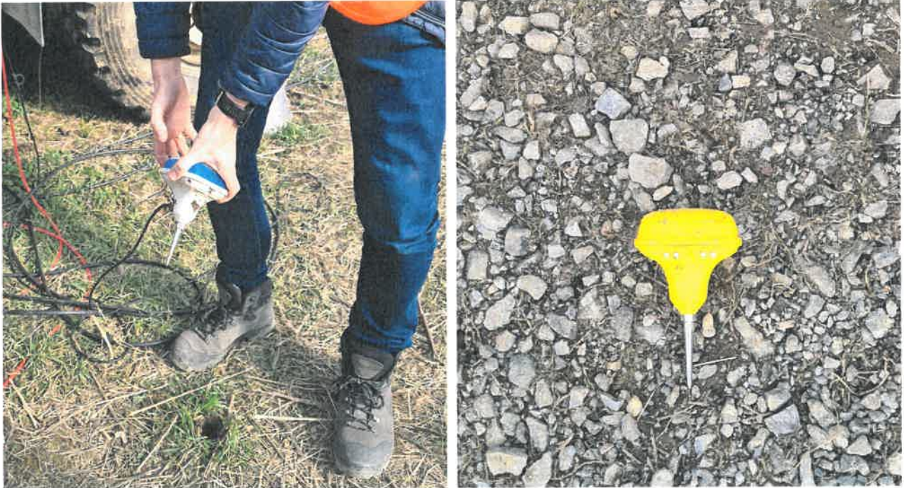
Slika 5. Prikaz geofona (prijamnika)
